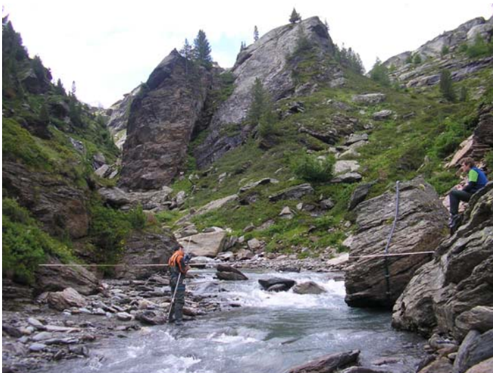
Misure con flow Tracker nel torrente Gavia
